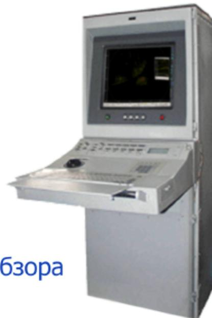
Когерентная твердотельная РЛС кругового обзора X-диапазона предназначена для:
